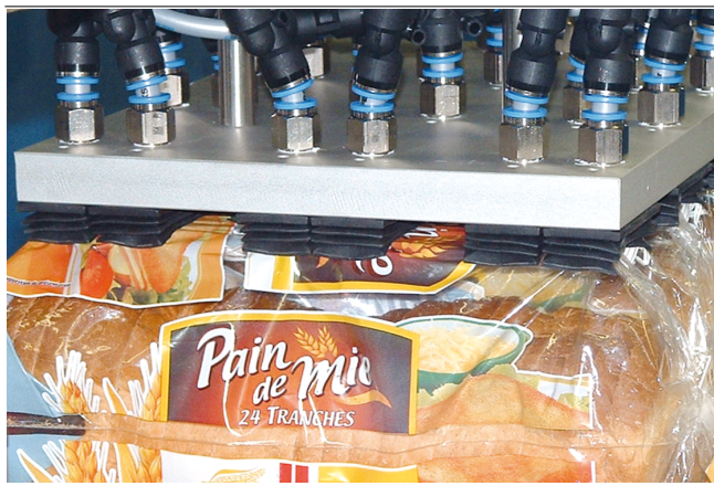
Ventosas de fuelle FSGB-R durante la manipulación de embalajes
